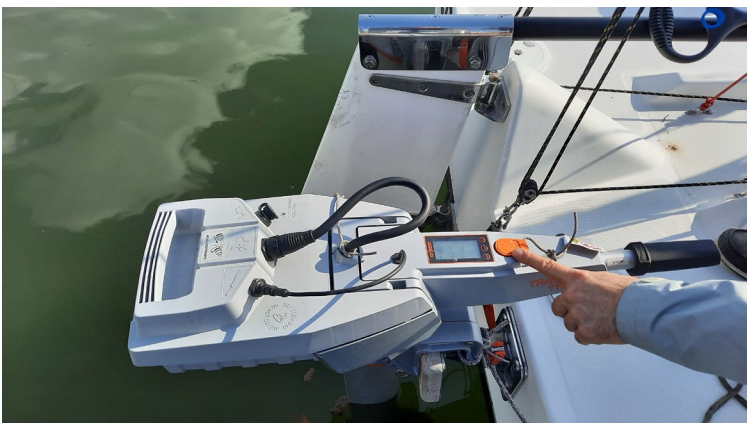
Bild B, Not-Aus, Abreißsicherung
